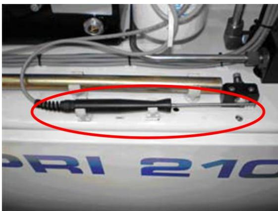
***Рисунок 5 – Ручной датчик-температуры***
